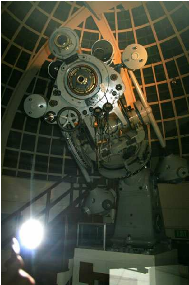
40 см. Рефрактор Карл Цейс. В настоящее время используется больше для демонстративных целей. Фото автора.
